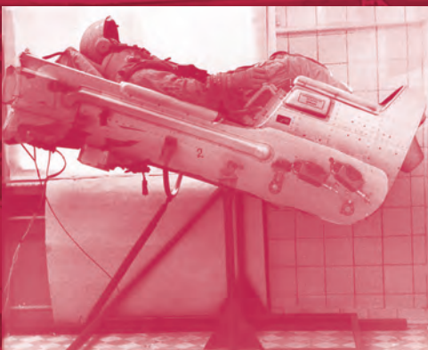
Тренировочный стенд с креслом космонавта. Фотография из отчета Центра подготовки космонавтов ВВС О подготовке женщин-космонавтов по пользованию ассенизационно-санитарным устройством-IV (АСУ-IV). Апрель 1963 г.
